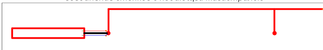
Соединение стояков с подающей магистралью
