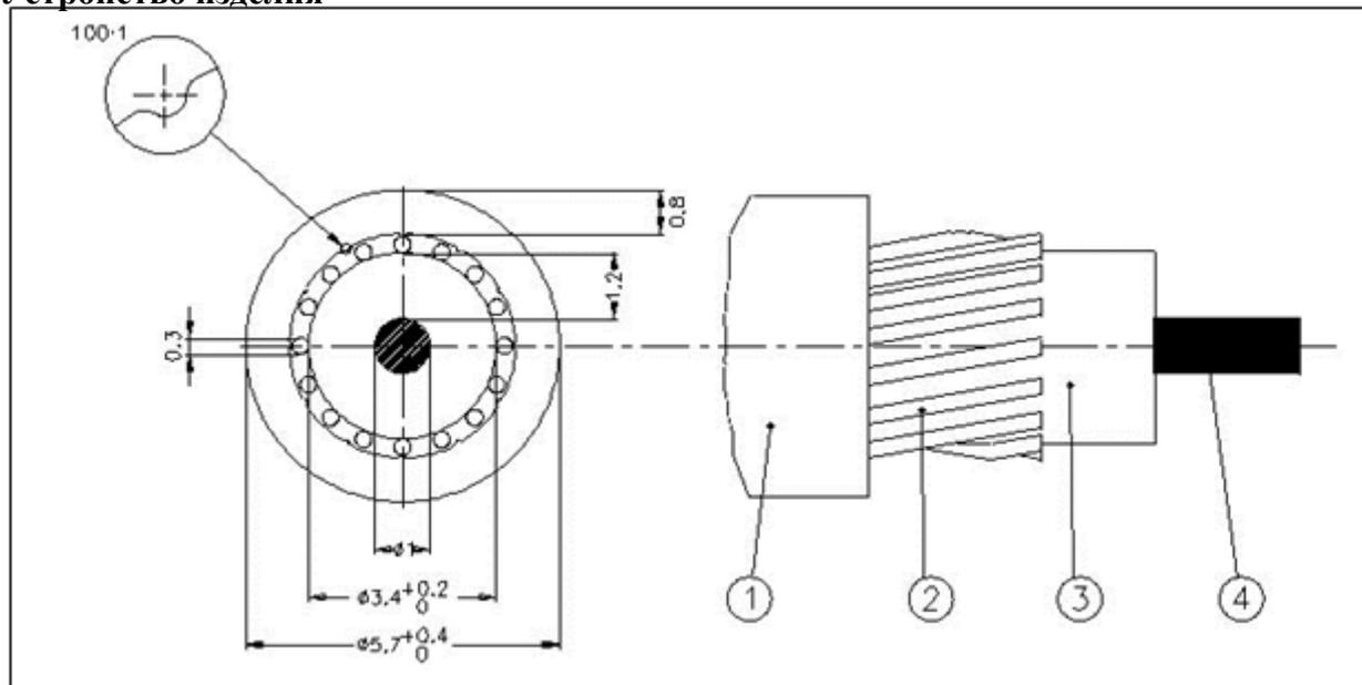
Рис. 2. Устройство нагревательного кабеля DEVIbasic™ 10S .
