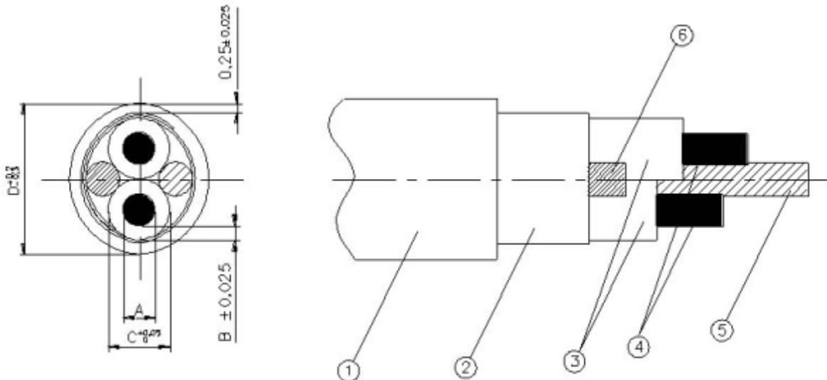
Устройство нагревательного кабеля, устанавливаемого в мате DEVIComfort™ 150T.
