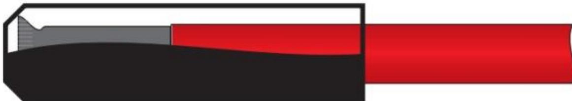
По окончании установки Т-образной соединительной муфты и концевой заделки сделать оценочную прозвонку нагревательных элементов 3-х отрезков саморегулирующихся кабелей. Измерить мегаомметром сопротивление изоляции. Его линейное значение должно быть не менее  $10^3$  МОм/м.
