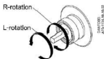
Вращение вала, расположение выхода форсунки и других соединений показаны с торца вала.
