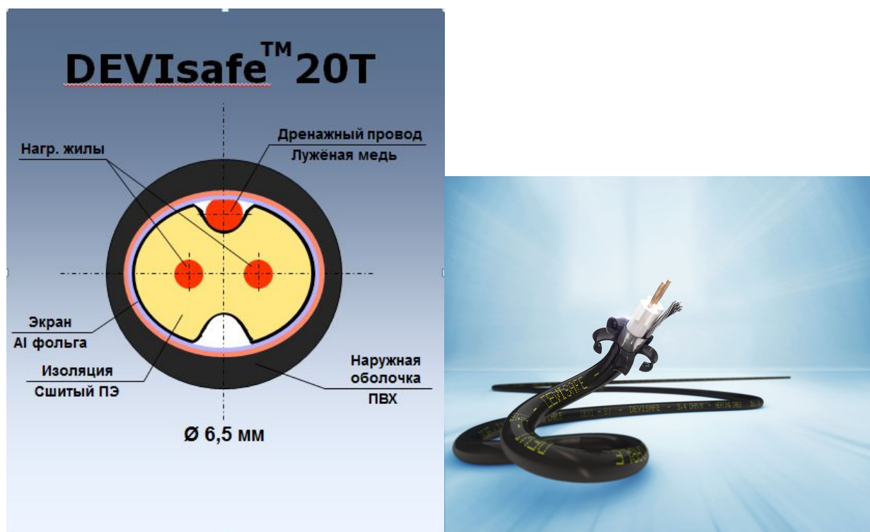
Рис. 2. Устройство нагревательного кабеля DEVIsafe™ 20T .
