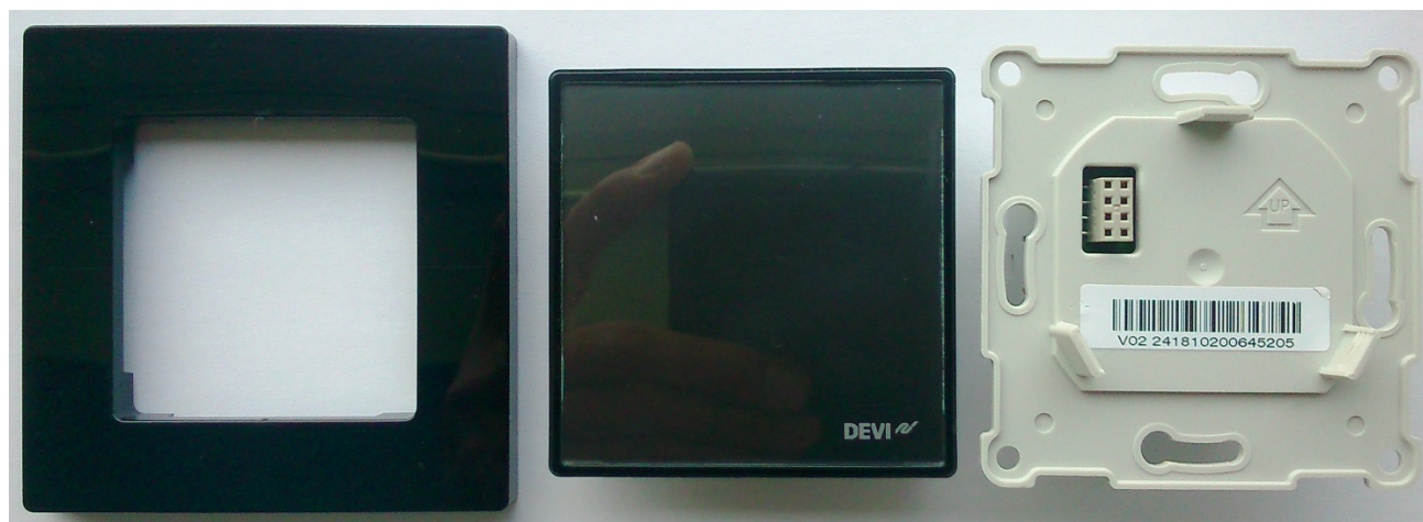
Рис. 3. Конструктивные части терморегулятора EStemp Smart.
